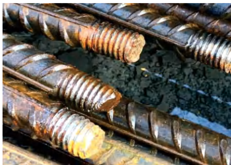
直螺纹端头马蹄形、不平齐、车丝长度不足
