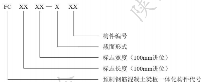
(a) 预制钢筋混凝土梁板一体化构件
