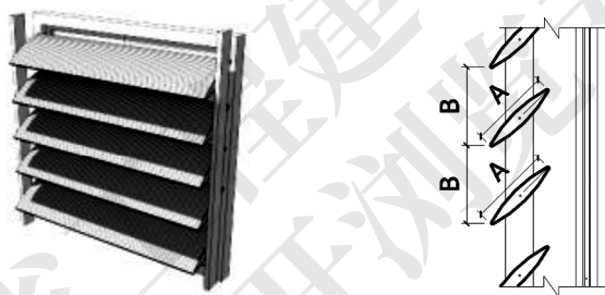
图 D.0.1-4 横百叶挡板式遮阳的特征值的示意图
